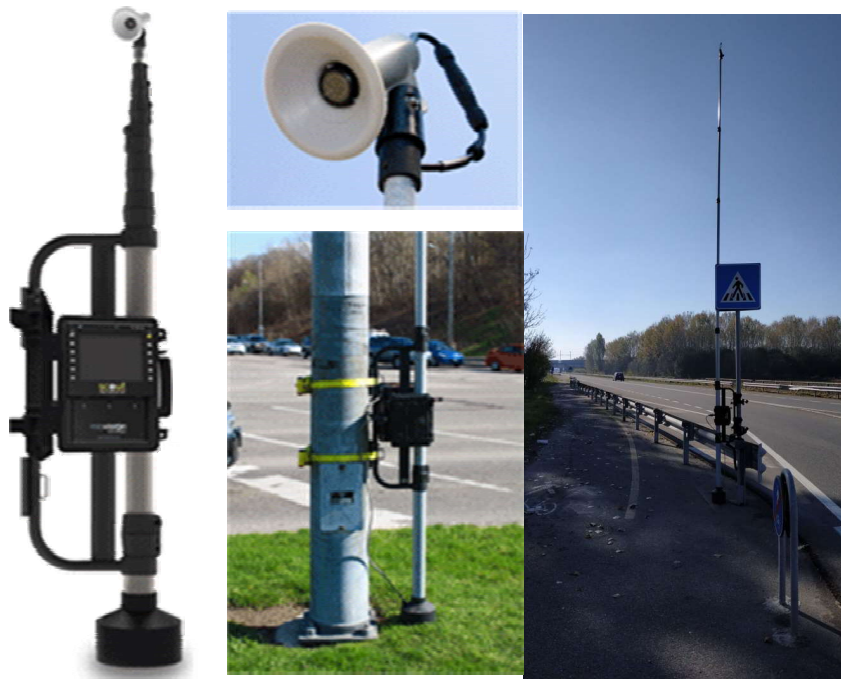
Figura 11 – Strumentazione video con palo telescopico
